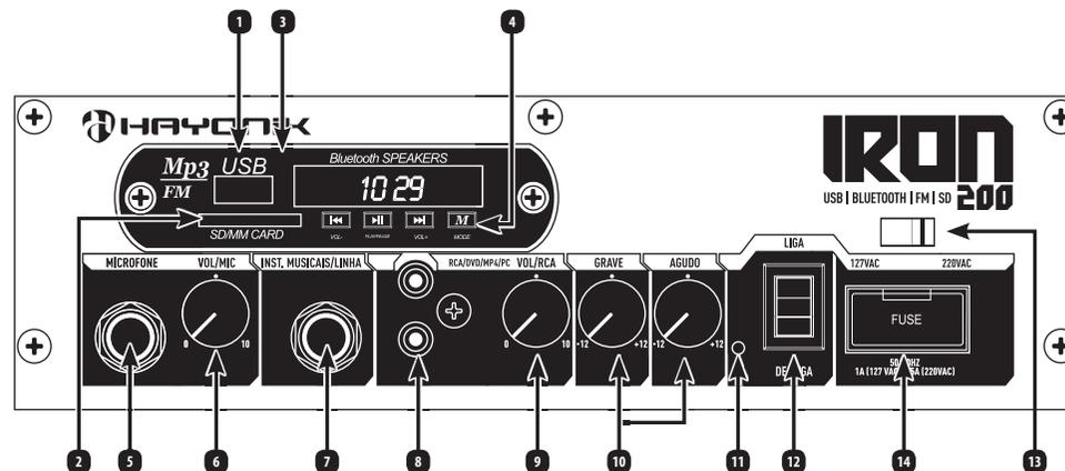
1 - CONEXÃO USB - Com Safe Eject (sistema para remover o dispositivo USB com segurança) para ser utilizado com Pendrives e MP3 Players (com a função de Pendrive). Atenção: HDs externos, Mp4 e Celulares não são compatíveis com este dispositivo.
