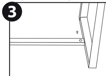
Coloque os parafusos Allen 8mm para prender as travas nos quadros laterais
