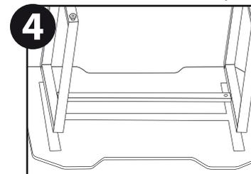
Após montado a base, encaixe-o na ranhura do tampo
