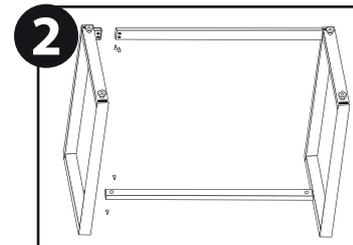
Encaixe o outro quadro lateral nas travas de apoio
