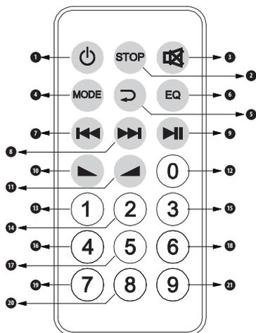
1. Tecla liga e desliga. Liga ou desliga o módulo USB/Bluetooth/FM/SD
